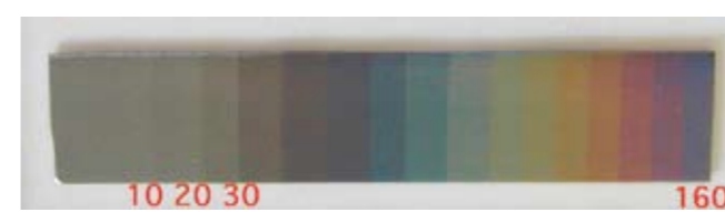
図1 100万分の1mmの高分子超薄膜を積み重ねることで得られる構造色。左から10枚、20枚・・・160枚と順に積み重ねることで様々な色を出すことができます。これは玉虫が見る角度によって色が変わる原理と同じです。
